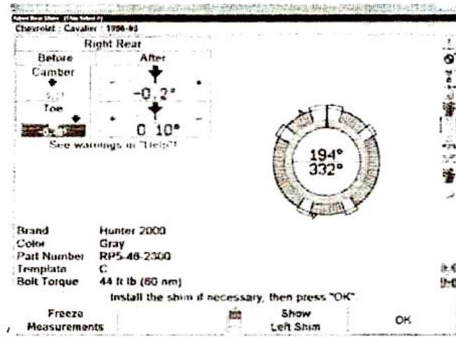
Для установки шайбы снимите колесо. После установки шайбы и колеса с мишенью и колесным адаптером мишень необходимо вновь откомпенсировать с помощью поддомкрачивания.
